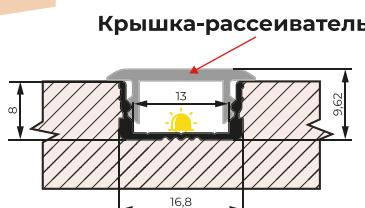
Устанавливается в фрезерованный паз **7,5 x 16,5 мм** в деталях корпуса ЛДСП. Боковые выступы в конструкции профиля призваны скрывать возможные сколы и неровности пропила.
