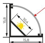
Монтаж угловой алюминиевой основы производится в место стыка дна/крышки и стенки (боковой, задней) на саморезы. Форма квадранта (1/4 круга) позволяет добиться равномерного освещения.
