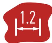
Толщина нержавеющей стали дна — 1,2 мм
